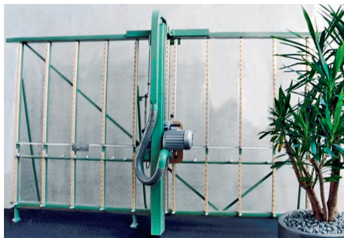
Das „Modell 62“: Rahmen und Balken sind aus Metall, ein Sägeaggregat ist bereits integriert
